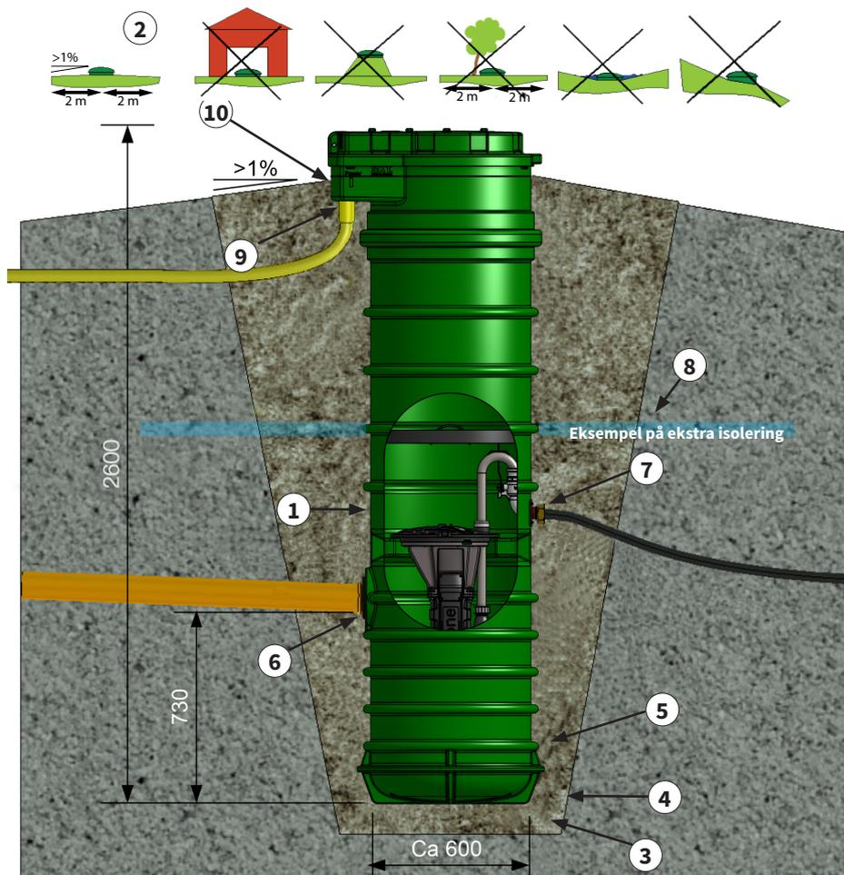
Ved større frostdybder kan installasjonen suppleres med isolasjon og / eller et ekstra isolasjonsdeksel i tanken.
